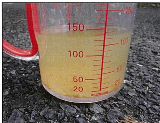
写真 4 観測孔内沈殿物
