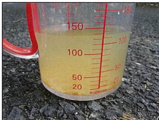
写真3 観測孔内沈殿物例
