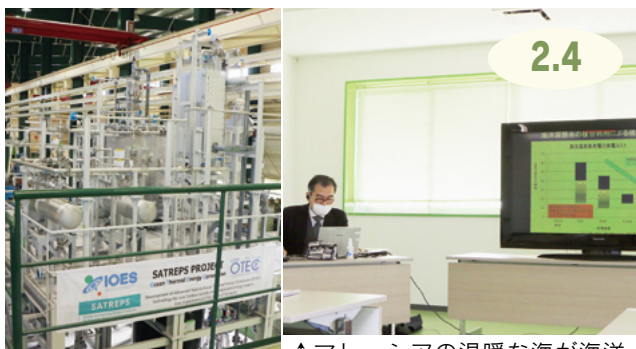
↑輸出するハイブリッド式海洋温度差発電装置
