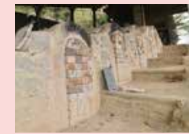
登り窯 昔ながらの薪で炊く登り窯。献上品の焼成などに使用されています。
