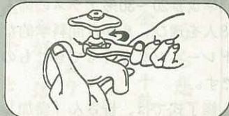
バルブをまわし水を止め、じゃ口を全開にして、パッキン押えの部分をはずす。
