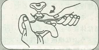
じゃ口をしめ、パッキン押えをしめ、止めたバルブをもとにもどす。
